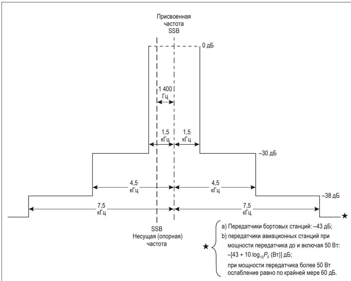
**Рис. 2-2. Пределы спектра частот (выраженные через максимальную мощность), требуемые для передатчиков бортовых станций, впервые установленных после 1 февраля 1983 года, и передатчиков авиационных станций, применяемых с 1 февраля 1983 года**
