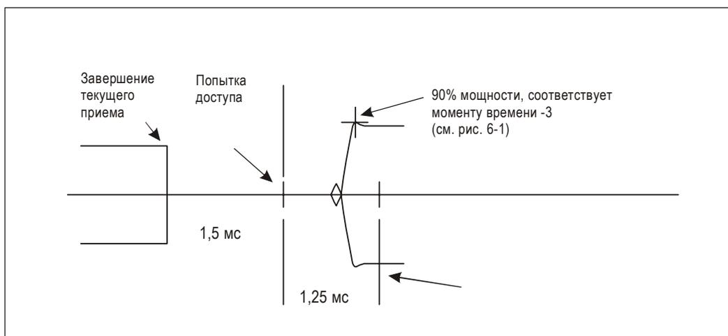
Рис. 6-3. Время перехода с приема на передачу
