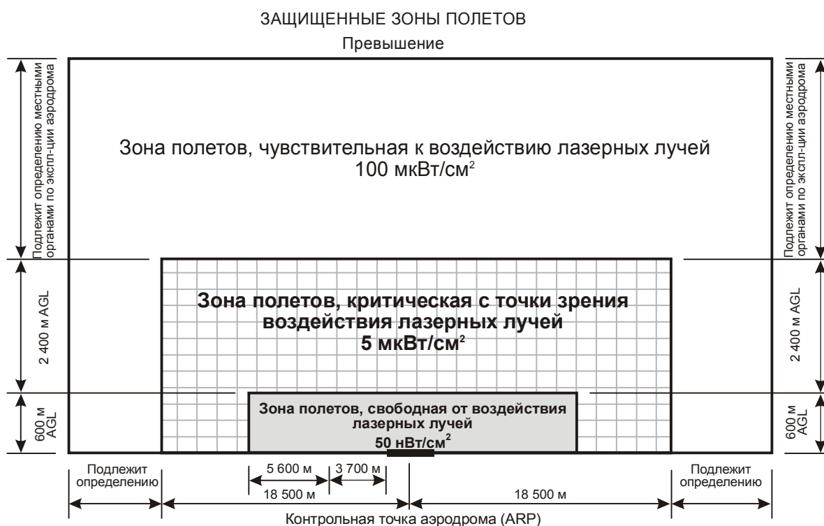
Рис. 5-13. Защищенные зоны полетов с указанием максимальных уровней излучения для видимых лазерных лучей
