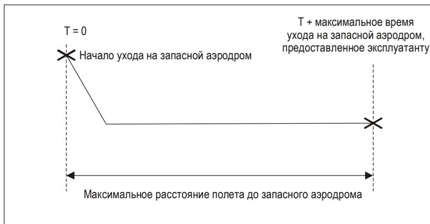
**Рис. D-9. Максимальное время ухода на запасной аэродром.
