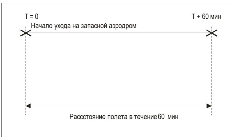
**Рис. D 3. Расстояние полета в течение 60 мин. Самолеты, имеющие более двух газотурбинных двигателей**
