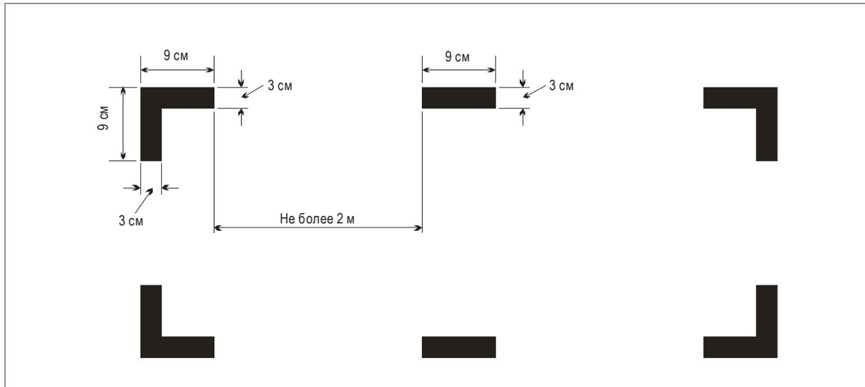
МАРКИРОВКА МЕСТ АВАРИЙНОГО ВСКРЫТИЯ ФЮЗЕЛЯЖА (см. п. 6.2.4)
